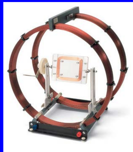
tzv. Helmholtzova cievka („vypína“ vonkajšie magnetické pole)
