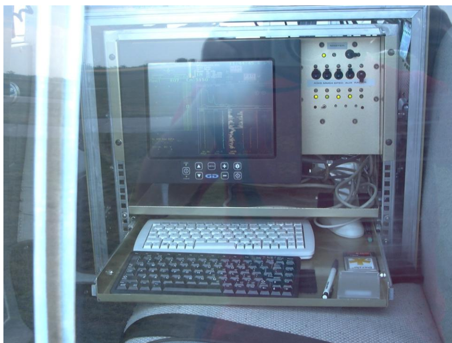
Obr. 22 LCD panel centrálnej jednotky leteckého systému Pico Envirotec AGIS
