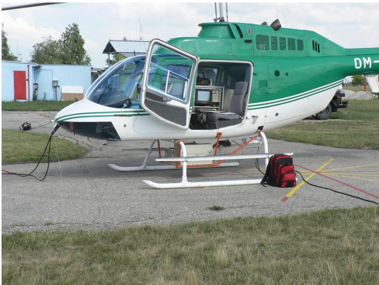
Obr. 23 Vrtuľník BELL 206 B s leteckým gamaspektrometrom Pico Envirotec GRS410 so 4+1 NaI(Tl) kryštálmi (21,0 l)
