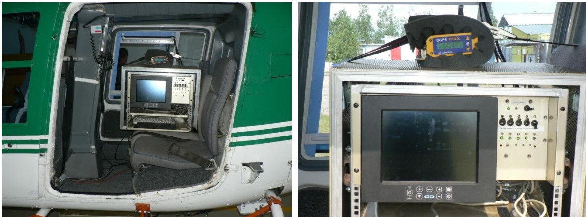
Obr. 18 Centrálna jednotka leteckého geofyzikálneho systému (Pico Envirotec AGIS)
