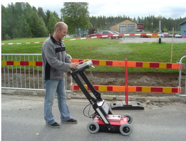
príklad merania radarom v teréne
