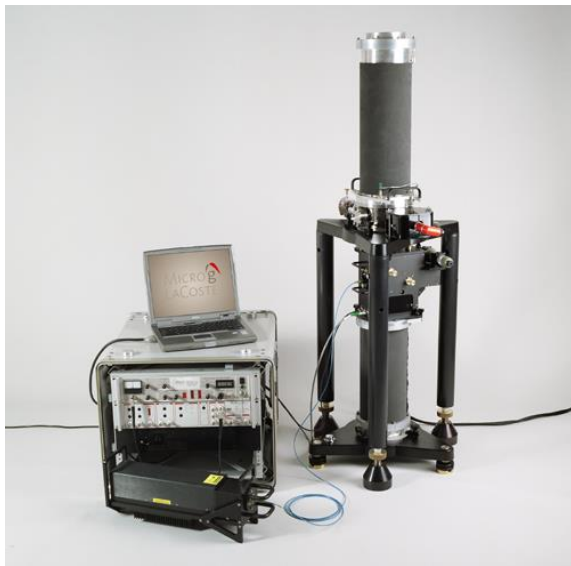
Micro-g FG-5 (laboratórny prístroj)
