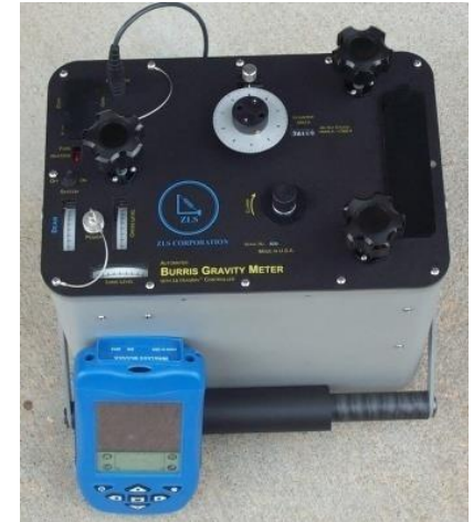
ZLS-Burriss (skratka pre Zero Length Spring)
