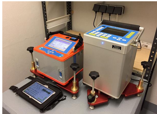
prístroje na meranie tiažového zrýchlenia Zeme - gravimetre
