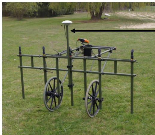
GPS antenna (snímanie polohy v reálnom čase s korekciami polohy cez GSM sieť – služba SKPOS)
