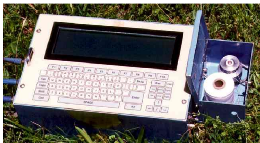
odometer (optické snímanie dĺžky odvinutej nite)
