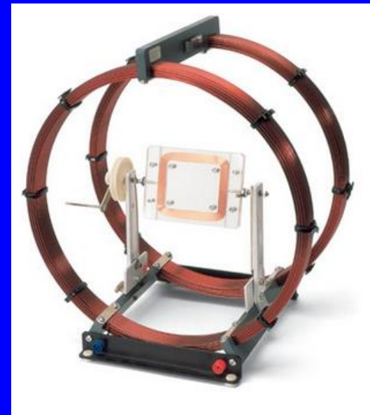
tzv. Helmholtzova cievka („vypína“ vonkajšie magnetické pole)
