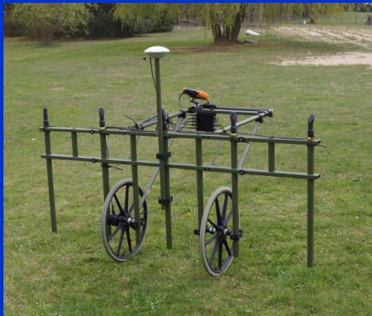
Často používané v archeológii v tzv. gradientovom prevedení (pole je merané v 2 úrovniach) a v multi-senzorovom usporiadaní.
