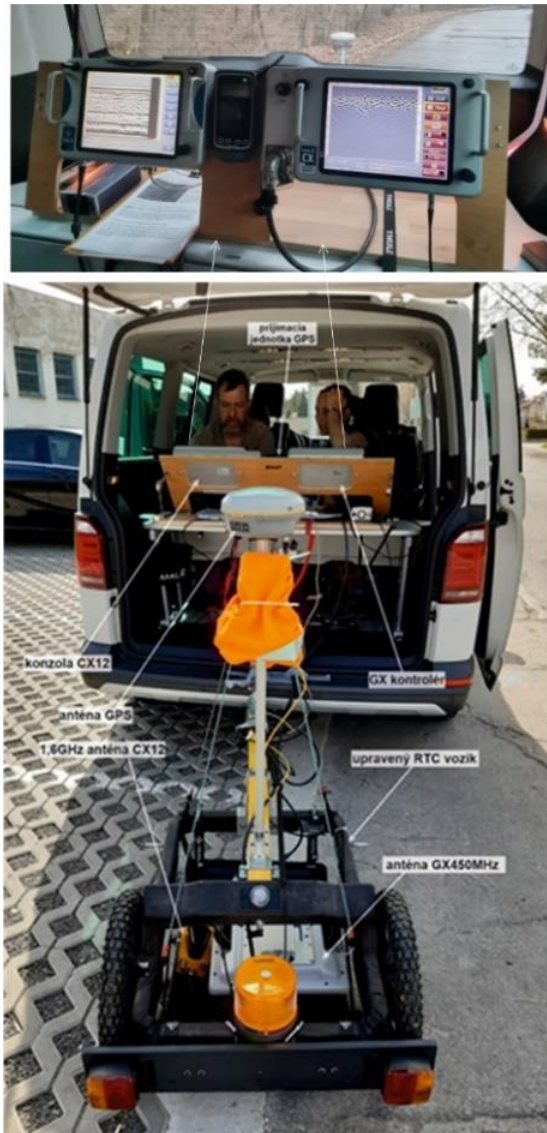
Obr. 7.43 Dvojfrekvenčný GPR systém CX a GX od firmy Mala - GX s anténou HDR 450 MHz a CX12 s vysokofrekvenčnou anténou so strednou vysielačou frekvenciou 1,6 GHz.
