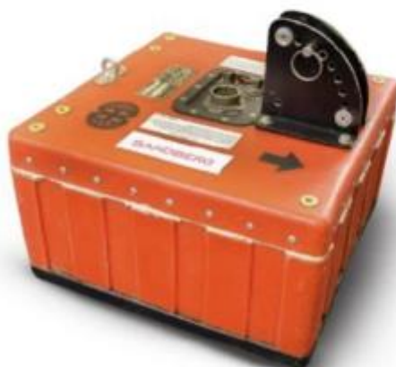
Obr. 3.15 a) Digitálna anténa GSSI 350HS s technológiou HyperStacking, ktorá výrazne zlepšuje hĺbku a výkon rozlíšenia dát v porovnaní s tradičnými analógovými anténami; b) klasická analógová 400 MHz anténa od firmy GSSI.
