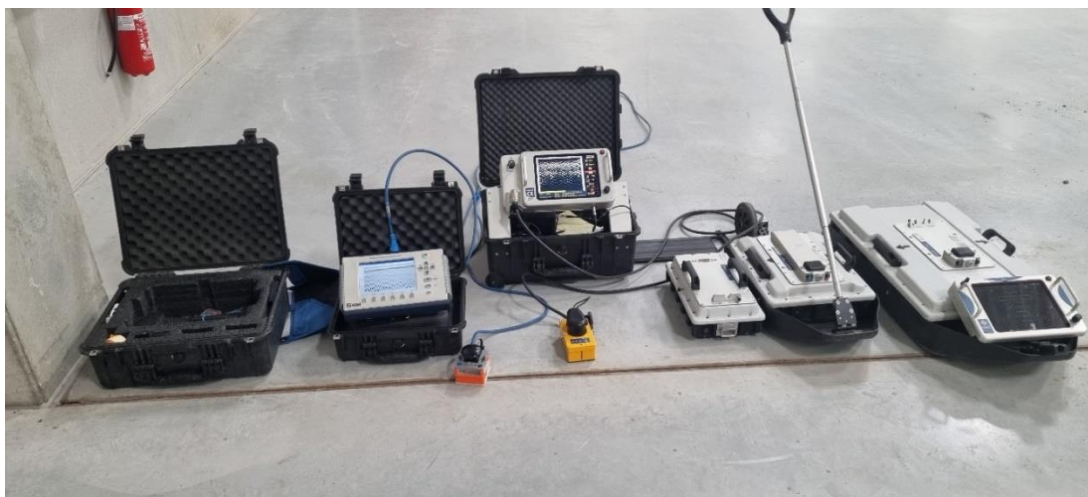
Obr. 7.20 Ukážka GPR systémov použitých pri testovacom meraní na podlahe z drátkobetónu - systém Mala GroundExplorer (GX) s anténami HDR (High Dynamic Range) s frekvenciami 750 MHz, 450 MHz a 160 MHz a systém GSSI s vysokofrekvenčnou anténou s centrálnou vysielačou frekvenciou 2 GHz.
