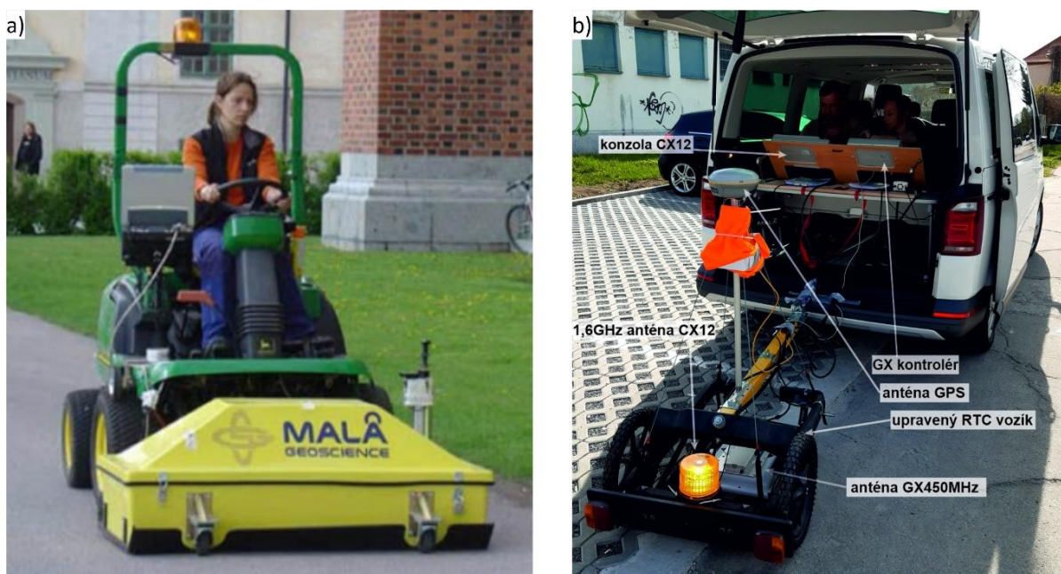
Obr. 3.14 Príklad anténnych systémov MALA: a) multikanálový s paralelným radením tienených antén rovnakej frekvencie (internetový zdroj 4), b) zostava cestného radaru merajúca naraz s viacerými anténami s rôznou frekvenciou s nezávislou systémovou konfiguráciou jednotlivých kanálov.
