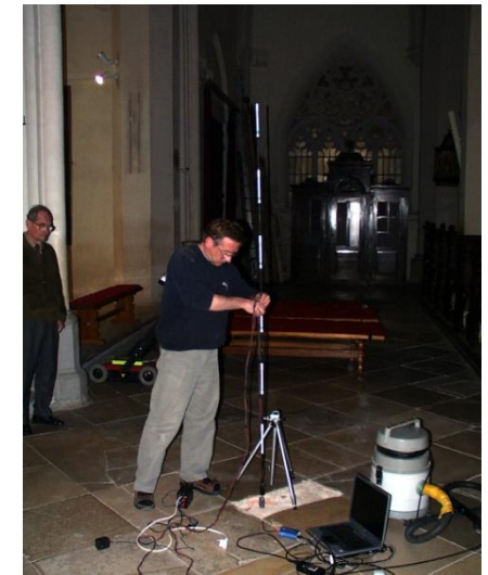
3. vsunutie kamery do otvoru
